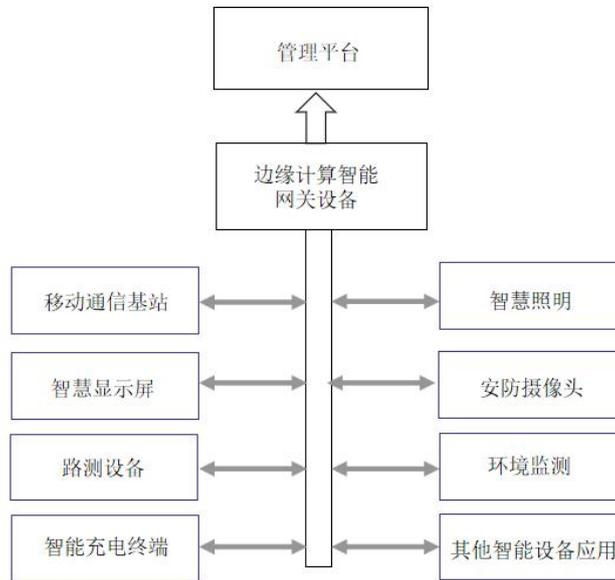
图 4 边缘计算智能网关示意图
